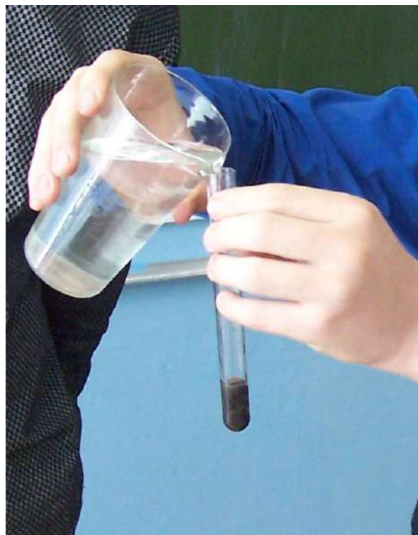
Рисунок 14. Приготовление водной вытяжки из почвы
