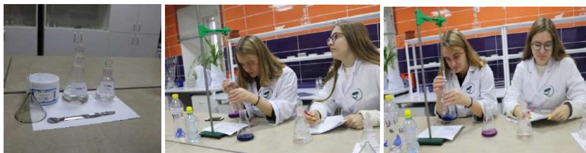
Фото 4-6. Определение общей жесткости
