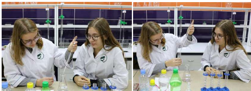
Фото 7-8. Определение сульфат ионов
