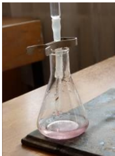
Рис. 8. Проведение титрования по определению содержания аскорбиновой кислоты в плодах жимолости съедобной (октябрь 2021 г.)
