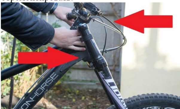
Рис. Проверка рулевой колонки на наличие люфта.
